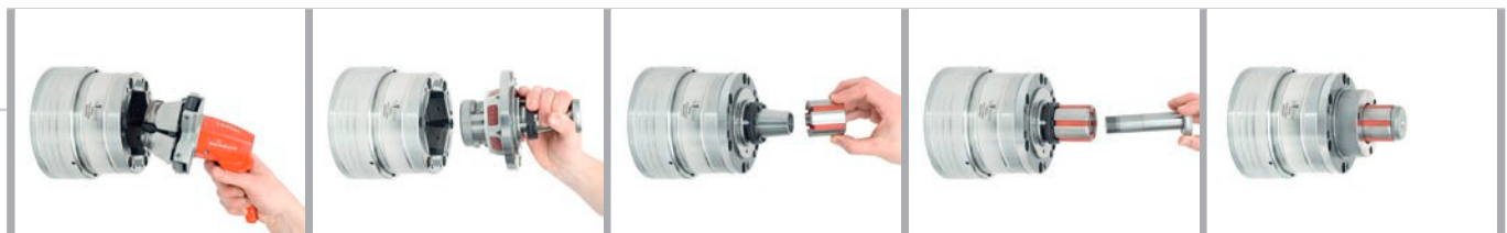
Retirer la tête de serrage et la butée de pièce
